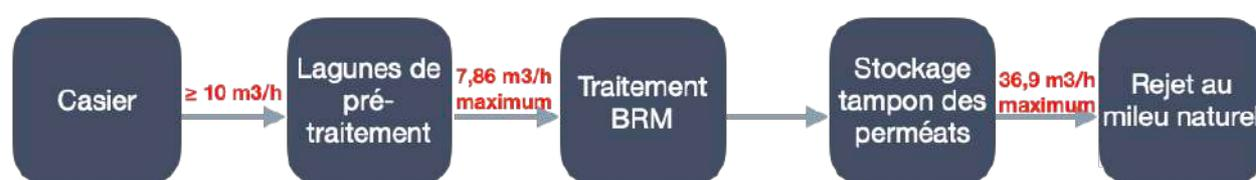
Figure 55 : Synoptique des débits de la filière de gestion et traitement des lixiviats
