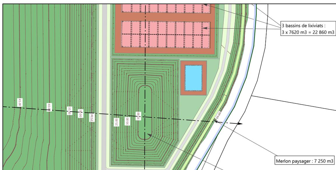
Figure 72 : Plan bassin de stockage des eaux de drainage du casier amiante
