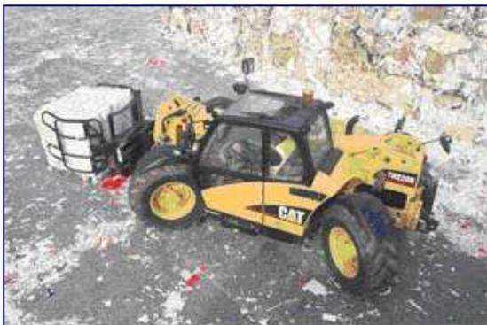
**Photo 27 : Chargeur à bras télescopique**
