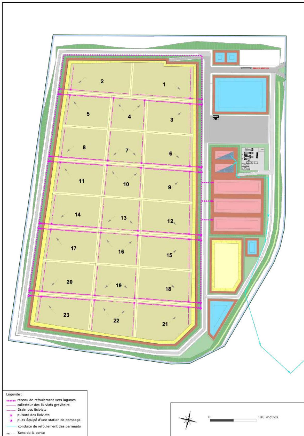
**Figure 51 : Plan du réseau de collecte des lixiviats**
